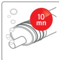
Le séchage s'obtient par la chaleur dégagée du moteur. Pour assurer l'étanchéité, laisser tourner le moteur à l'air libre pendant 10 mn.
