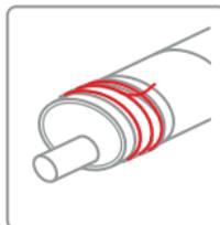
Renforcer le tout en enroulant du fil de fer le long de la réparation.
