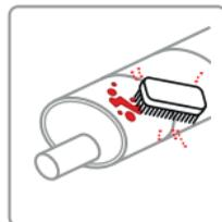
A l'aide d'une brosse métallique ou d'abrasif, éliminer les parties endommagées et rouillées. Humidifier la zone à réparer.
