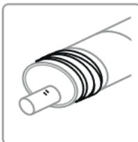
Enfiler des gants de protection, puis appliquer le Bandage Spécial Echappement autour de la zone à réparer.
