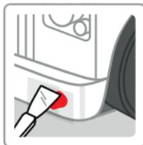
La résine restant poisseuse, la recouvrir de Mastic de Finition à l'aide d'une spatule. Poncer à l'abrasif P100 et P180.
