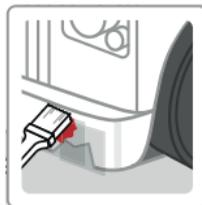
Appliquer 1 couche de résine, puis le Mat de Verre. Imprégner de résine jusqu'à transparence du mat. Renouveler l'opération, mouillé sur mouillé, avec des morceaux de mat de taille croissante. Laisser durcir.
