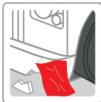
Préparer le support en dégraissant la zone à réparer à l'aide d'un chiffon et du Super Nettoyant. Poncer.
